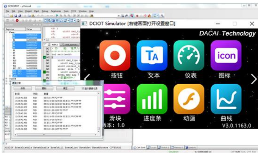
图 13-3Keil 开发环境与虚拟串口屏绑定调试
