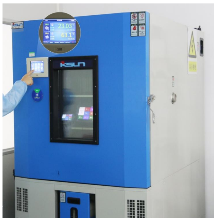
图 7-3 高低温老化测试图
