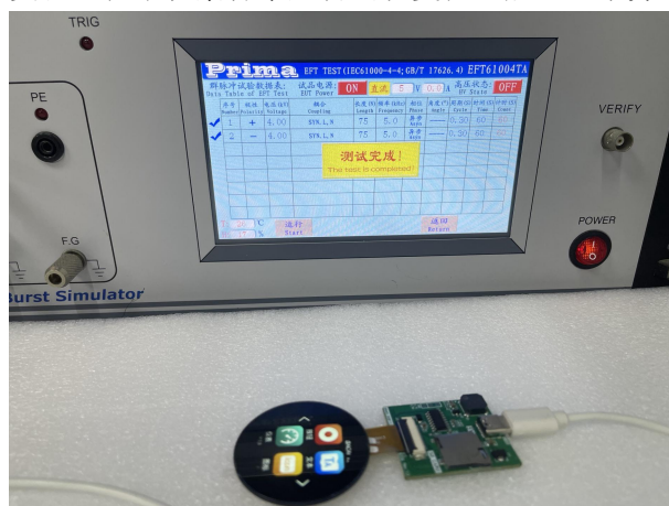
图 7-4 群脉冲测试图
